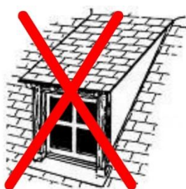
lucarne rampante ou en chien couché
